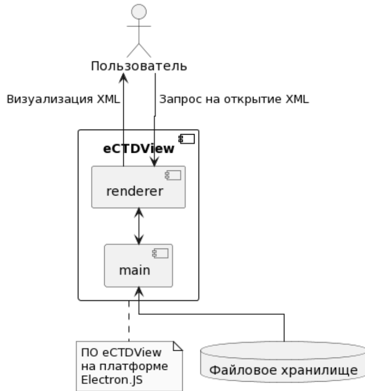
Рисунок 1. Схема взаимодействия компонентов ПО eCTDView
